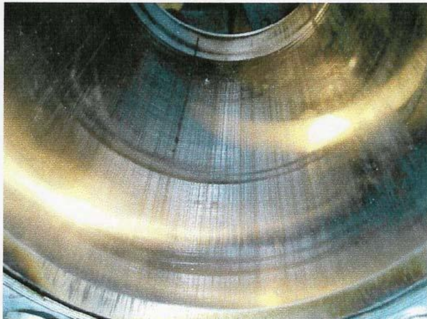
Рис.2. Фотография рабочей поверхности нового цилиндра дизеля В-55 после обкатки в штатном режиме. Видны натирки на поверхности.
